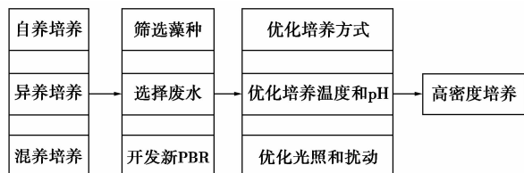
图 1 微藻在废水中的高密度培养工艺
