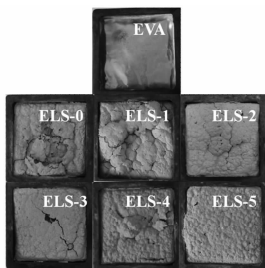
图 4 CCT 后炭渣的电子照片
