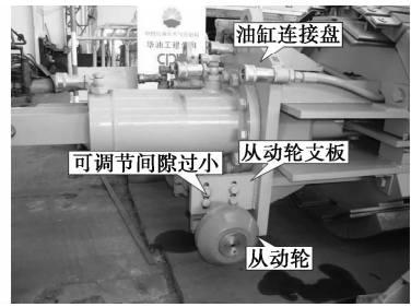
图 2 原内胎从动轮支板结构
