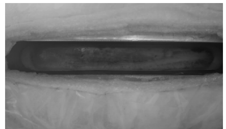
图7 抑制剂质量分数为1.5%时水合物生成图片
