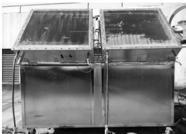
图 2 蓄热式倾斜芯型太阳能蒸馏器装置
