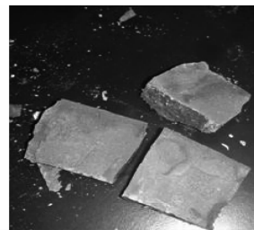
图 1 未加增韧剂的固结物破坏结果
