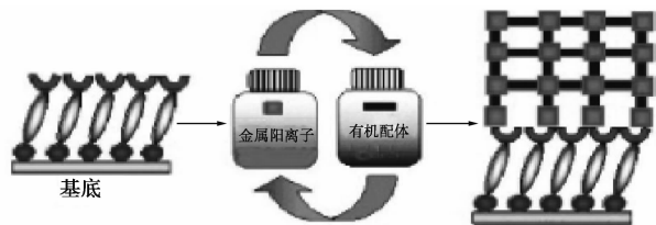
图 2 液相外延法制备 MOF 膜
