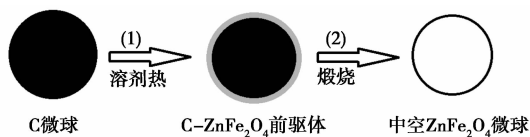
图 1 中空 \text{ZnFe}_2\text{O}_4 微球的制备过程和形成机理
