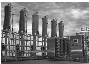
图 8 VSEP 工业应用设备装置图
