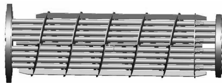
图1 螺旋折流板换热器管束 Pro/E 三维模型
