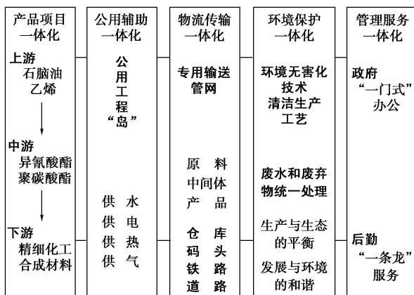
图2 上海化工园区“一体化”理念联合生产模式发展循环经济概念示意图
