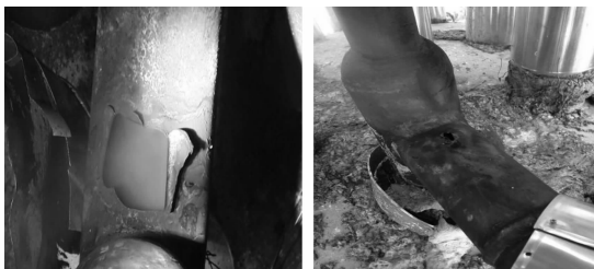
图3 管束结构和管束爆裂位置图
