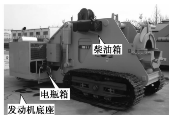
图 2 原冷弯管机柴油箱、电瓶箱、发动机底座示意图
