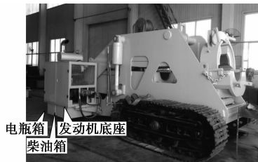
图4 新型发动机底座整机示意图
