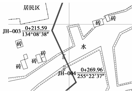
图4 管道中线自动标注实例
