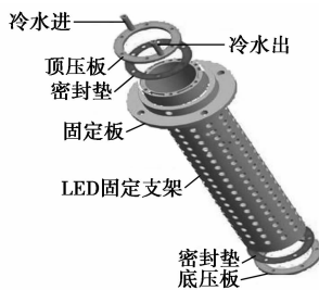
图4 强制水冷结构原理图
