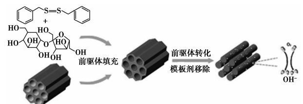
图3 OMC-S 制备及催化 ORR 反应示意图
