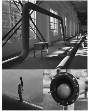
图7 研制的内检测器环道试验
