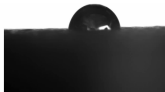
图 3 无涂膜表面接触角
