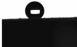
图 2 所制涂膜表面接触角
