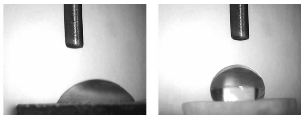
(a) 水滴在未经十四酸处理的氧化铝镀层的接触角
