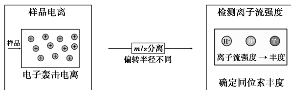
图 1 质谱分析氢同位素的原理示意图
