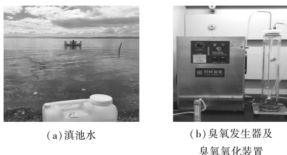
图 1 实验水样及所用臭氧发生器及臭氧氧化装置
