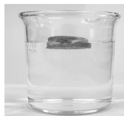
图 6 Cel/PVA/SA@MTCS 吸油后的漂浮性
