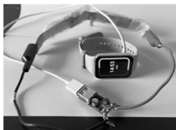
(a) 基于 PVA-CHI-5 的锌空气电池电子器件充电测试
