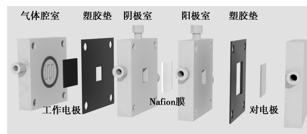
图 1 流动电解池的构造
