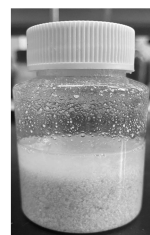
图 1 A 型胶囊防垢剂的外观结构照片
