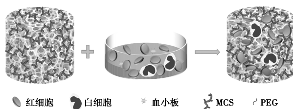
图 4 改性止血海绵的止血功能示意图
