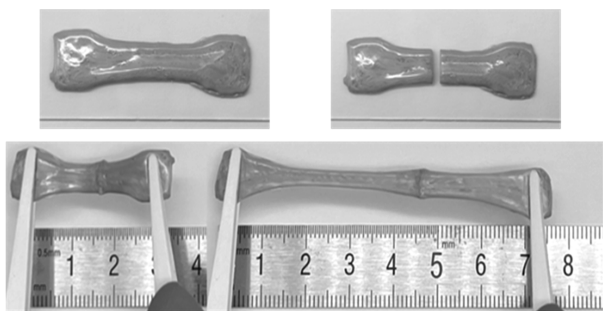
(b) 3D 打印骨头状样条自修复过程
