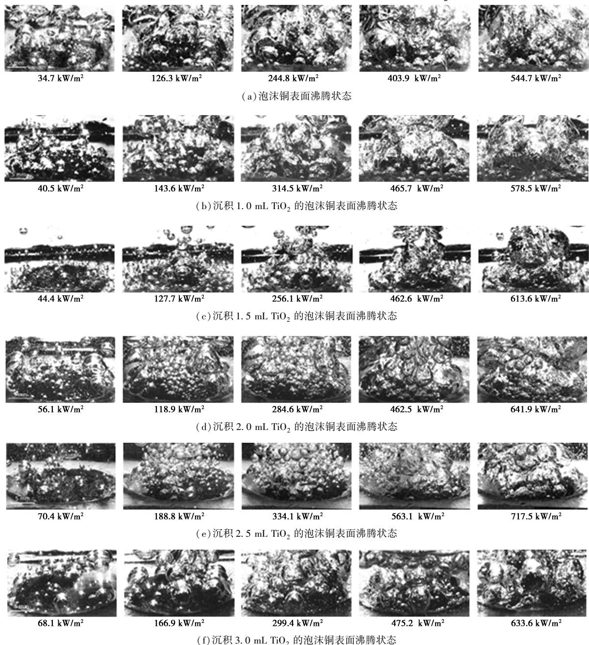
图 4 沉积不同量 TiO 2 的泡沫铜表面沸腾状态
