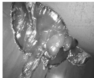
图 4 粗苯乙烯塔釜聚合物
