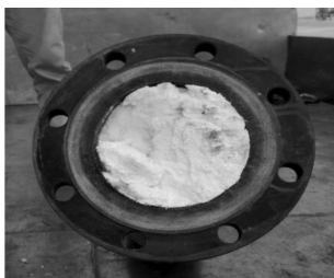
图 5 薄膜蒸发器气相线聚合物
