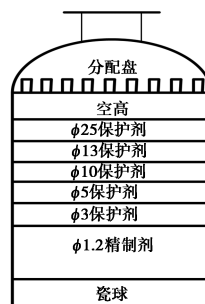
图1 反应器床层催化剂装填示意图
