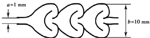
图 1 微通道脉冲混合结构
