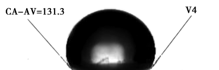
图 5 硅氧烷质量分数为 5% 时乳液膜的水接触角
