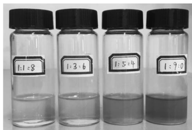
图 6 切削液稳定性实验结果
