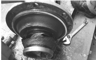
图 2 烷基化装置动设备腐蚀案例
