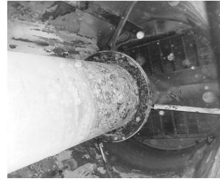
图3 洗涤塔内因水质差导致的结垢现象
