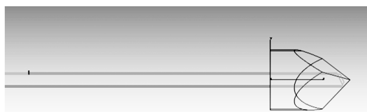
图2 垂直入射光束反射镜角度
