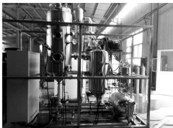
图2 MVR热泵放射性废液蒸发浓缩系统
