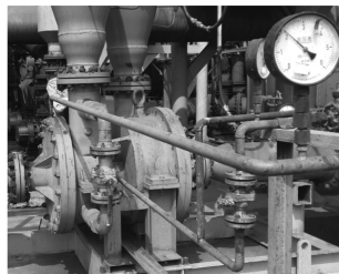
图9 透平增压泵现场运行图
